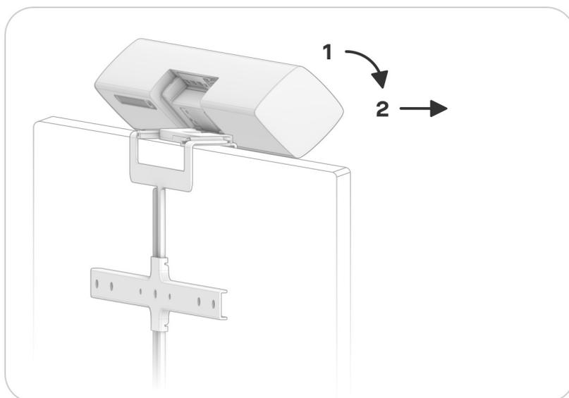
**Внимание!** Не оставляйте Neat Bar в максимальном положении наклона, если виден красный индикатор. Это значит, что устройство не закреплено пружинным фиксатором.
